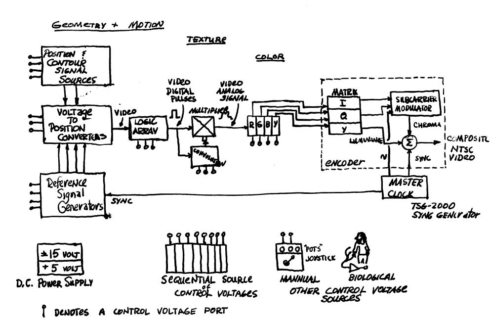
FIGURE 1: DIRECT VIDEO SYNTHESIZER SYSTEM BLOCK DIAGRAM
